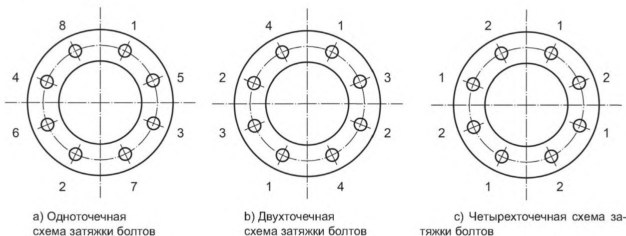
Рисунок G.2 — Перекрестная последовательность затяжки болтов одним, двумя и четырьмя инструментами одновременно
